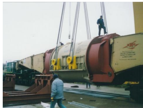
Rys.3. Przewóz modułów urządzeń dla przemysłu rafineryjnego firmę C.Hartwig – Katowice S.A. [8] Rys.4. Rozładunek z wagonu typu NORCA generatora o ciężarze 330 ton przez firmę Metalchem Serwis Sp. z o. o. [9]
