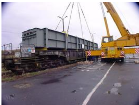
Rys.3. Przewóz modułów urządzeń dla przemysłu rafineryjnego firmę C.Hartwig – Katowice S.A. [8] Rys.4. Rozładunek z wagonu typu NORCA generatora o ciężarze 330 ton przez firmę Metalchem Serwis Sp. z o. o. [9]
