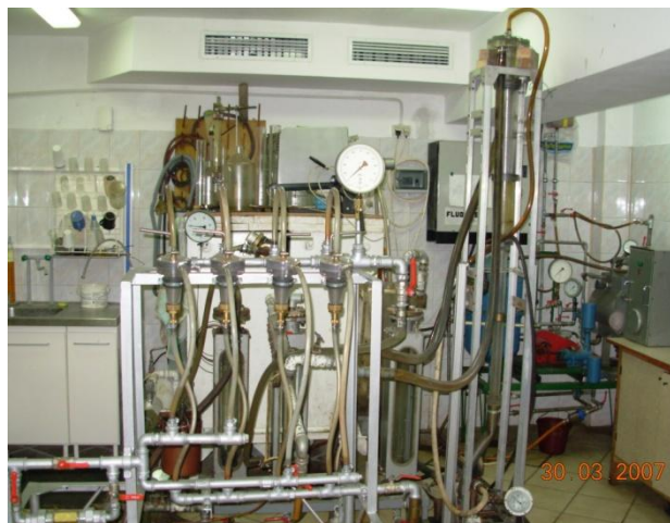
Fot. 1. Stanowisko hydrocyklonów JS-40 sprzęgnięte z hydrocyklonem modelowym Li (zdjęcie autorów) Photo 1. Hydro cyclone JS-40 stand coupled with model hydro cyclone Li (author's photo)
