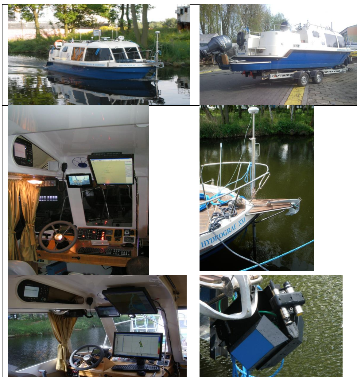
Rys.2. HYDROGRAF XXI – jednostka hydrograficzna Akademii Morskiej w Szczecinie wykorzystywana do pozyskiwania danych w procesie produkcji elektronicznych map nawigacyjnych.
